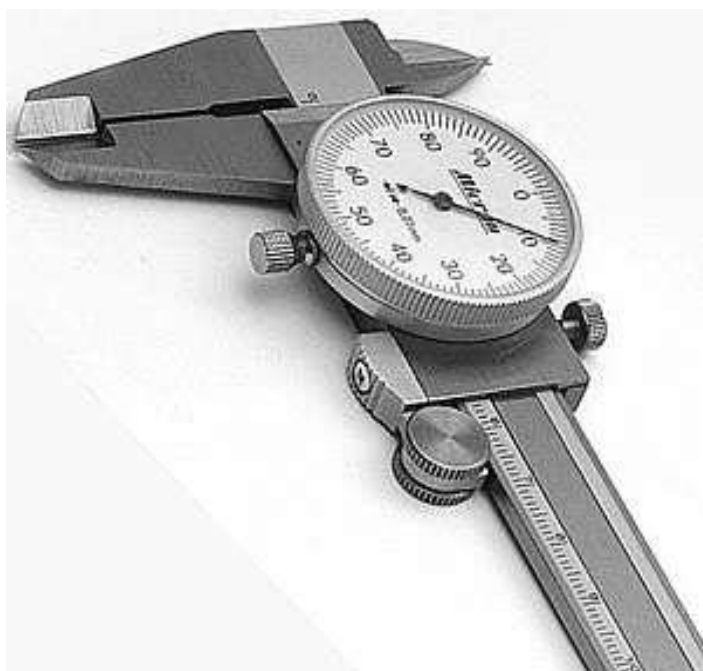
Рис.4 Штангенциркуль со стрелкой на круговой шкале
