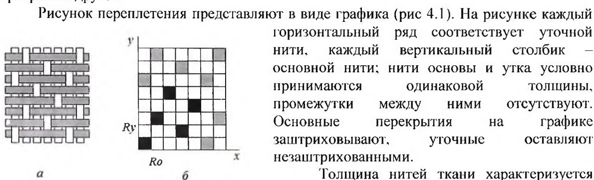
Рисунок 4.1 – Схема (а) и график (б) ткацкого переплетения
