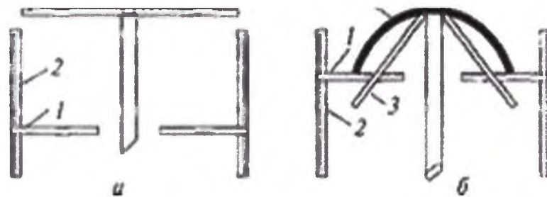
Рис. 6.1.– Схема прибора ПТ-2 для определения жесткости материала методом консоли: а) – при поднятой опоре; б) – при опущенной опоре; 1 – указатель прогиба; 2 – шкала; 3 – опора; 4 – проба; 5 – груз
