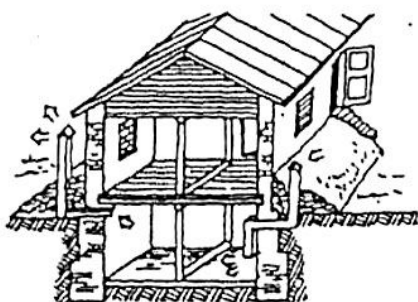
Противорадиационное укрытие в подвале дома
