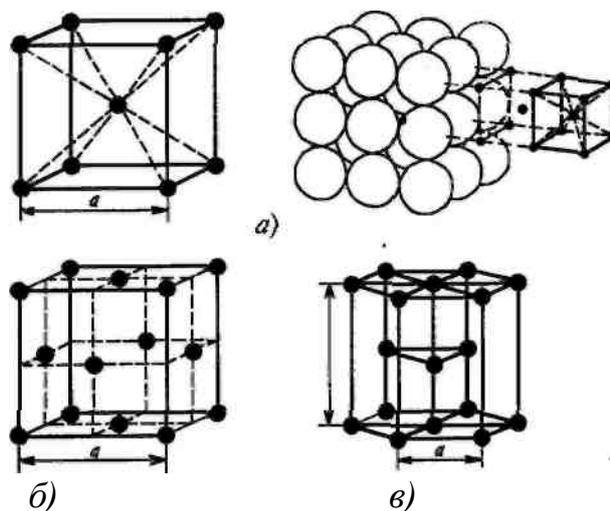
Рисунок 2 – Кристаллические решетки металлов:  $a$  – объемно-центрированная кубическая;  $б$  – гранецентрированная кубическая;  $в$  – гексагональная плотноупакованная
