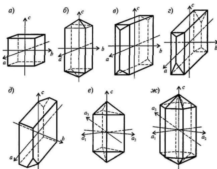
Рисунок 1 – Кристаллографические сингонии: а – кубическая; б – тетрагональная; в – ромбическая; з – моноклинная; д – триклинная; е – тригональная; жс – гексагональная
