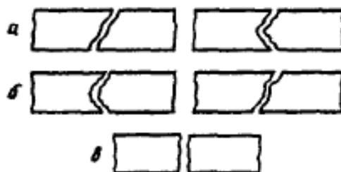
Рисунок 6 – Виды разрушения: а – сдвигом; б – частичным сдвигом; в – от нормальных напряжений
