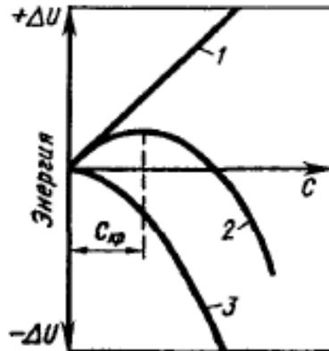
Рисунок 4 – Схема изменения энергии системы при росте трещины (по Гриффитсу): 1 –затраты энергии на образование новых поверхностей; 2 – изменение общей энергии; 3 – высвобождающаяся свободная энергия.
