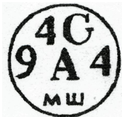
Рисунок 22 – Поверительное клеймо метрологии
