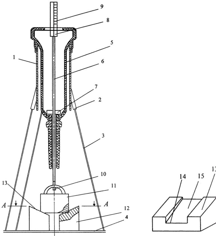
Рисунок 21 – Прибор для определения жесткости сосковой резины
